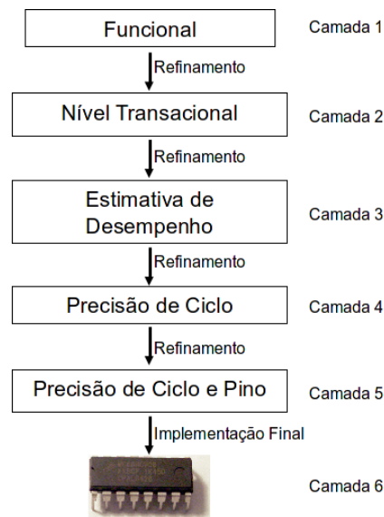
Figura 2 - Processo de refinamento de plataforma segundo a abordagem de projeto baseado em plataforma.
