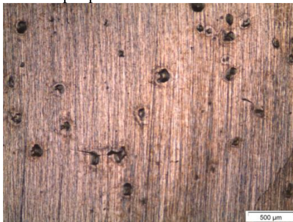
Figura 12 – Corrosão por pites.
